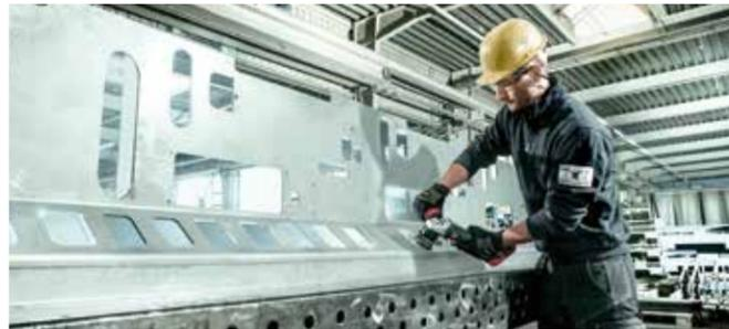
Das Entgraten nach dem Zuschnitt ist häufig eine zeitaufwendige und filigrane Handarbeit. Besonders an großen Bauteilen ist ein automatisiertes Entgraten oft nicht möglich. Daher wird es höchste Zeit, um hier Ihre Produktivität zu steigern – indem Sie in Zeitersparnis investieren.
