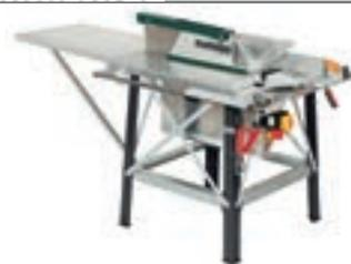
Lieferumfang: Hartmetall-Sägeblatt mit Flach-Trapezzahn (28 Zähne), Parallelanschlag, Winkelanschlag mit Keilschneidlade, Tischverlängerung, Schutzhaube, Kranhaken, Schiebstock
