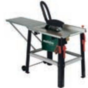
Lieferumfang: Hartmetall-Sägeblatt mit Wechselzahn (24 Zähne), Fahrgestell inkl. Handgriffe, Universalanschlag, Tischverlängerung (550 x 800 mm), Späneabsaugereinrichtung, Schiebestock
