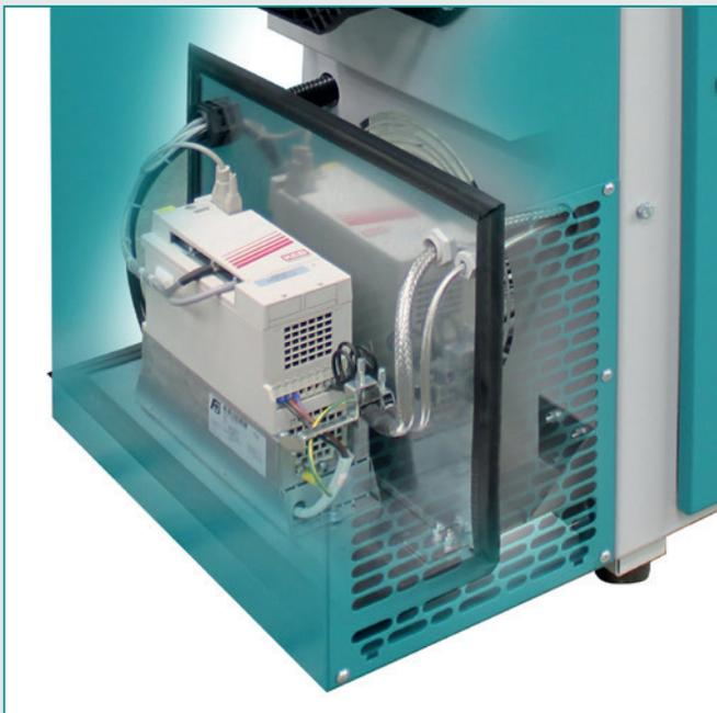
Der Frequenzumrichter wird durch eine Trennwand von der Zuluft der Maschine getrennt und somit bestmöglich vor Verschmutzung geschützt.
