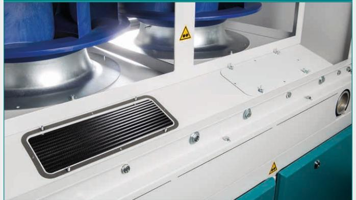
Der liegend verbaute Kühler kann über die Reinigungsklappen gereinigt werden. Alternativ kann der Kühler auch, wie eine Schublade zum Reinigen herausgezogen werden. Durch großzügig dimensionierte Öl- und Druckluftnackkühler sowie die integrierte Öltemperaturregelung laufen die Anlagen auch bei hohen Umgebungstemperaturen einwandfrei.
